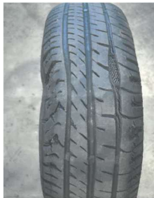
経年劣化と熱により 変形したタイヤ(軽自動車)
